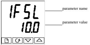
Figure 2-6 Typical parameter display
